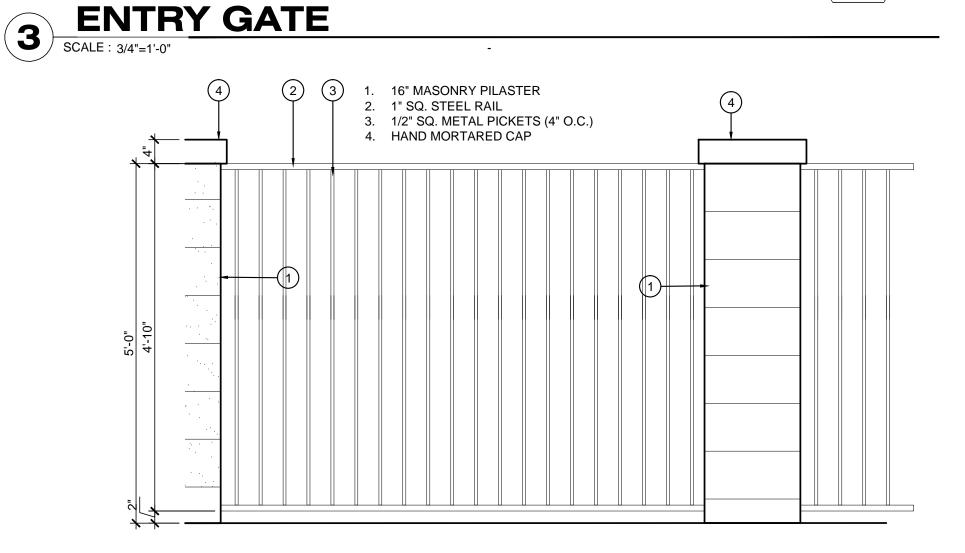
TYPICAL POOL FENCE ELEVATION
