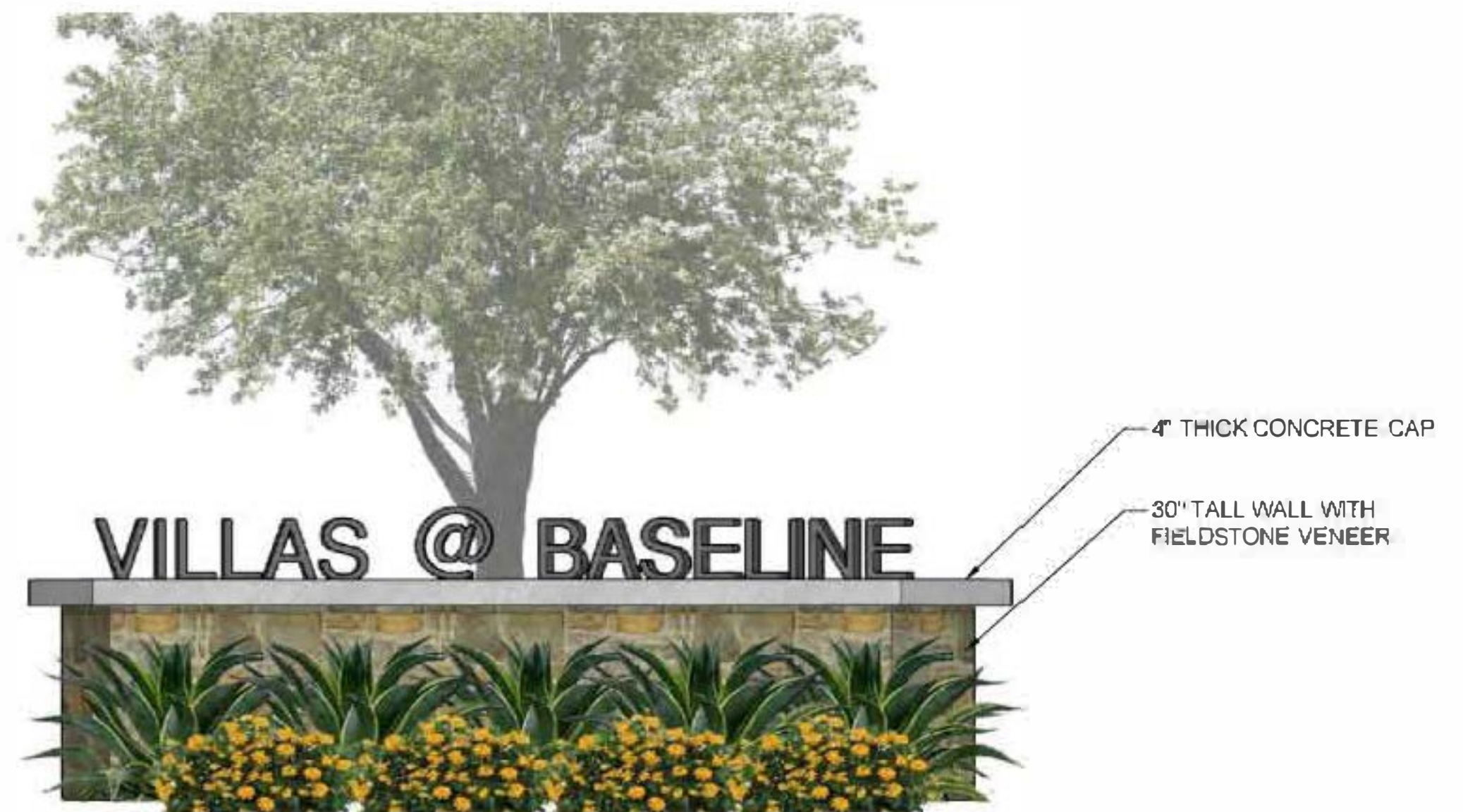
1 ENTRY SIGN ELEVATION N.T.S.
