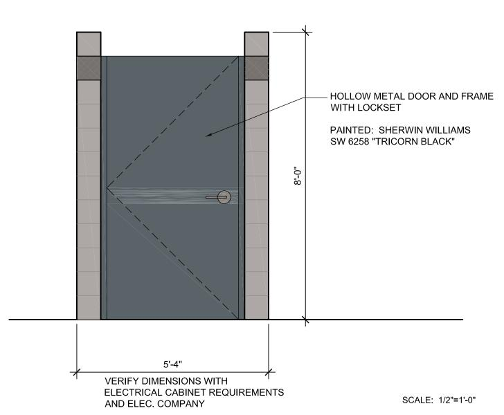
(6) ELECTRICAL (SES) ENCLOSURE FRONT ELEVATION
