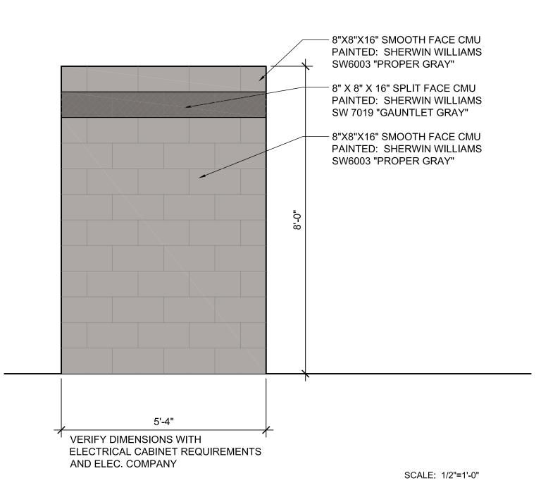
4 ELECTRICAL (SES) ENCLOSURE BACK ELEVATION
