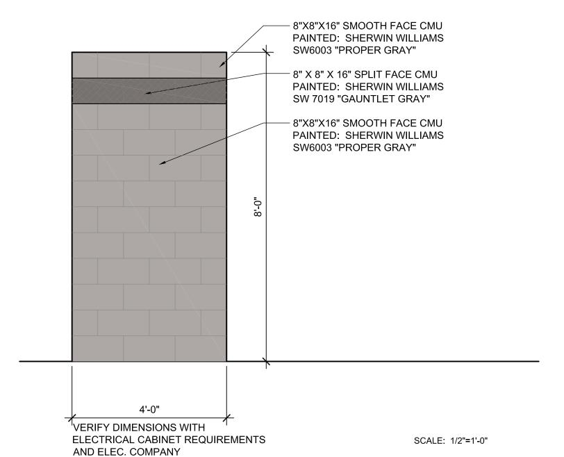
5 ELECTRICAL (SES) ENCLOSURE SIDE ELEVATION
