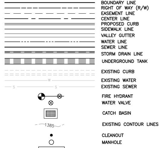
RIGHT OF WAY (R/W) SIDEWALK LINE VALLEY GUTTER SEWER LINE STORM DRAIN LINE UNDERGROUND TANK
