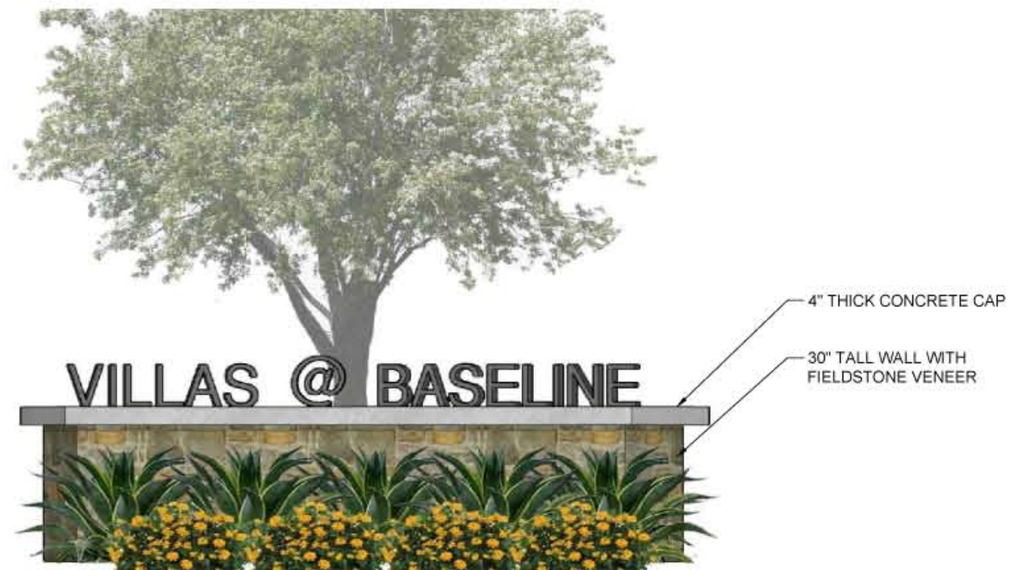
1 ENTRY SIGN ELEVATION N.T.S.
