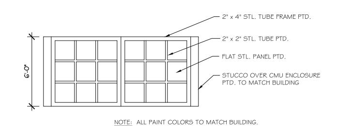
TRASH ENCLOSURE ELEVATION
